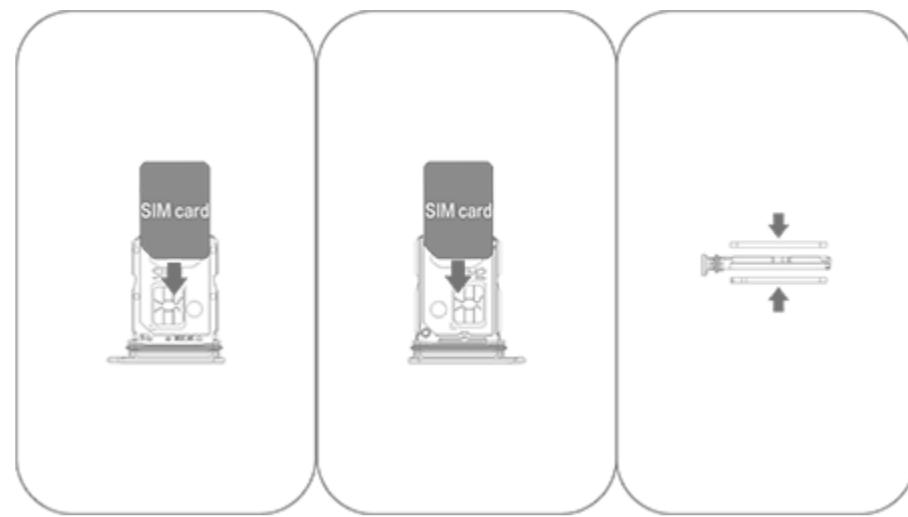
3. Tieni il dispositivo rivolto verso l'alto e fai scorrere il vassoio completamente nello slot nella direzione indicata dalla freccia.
