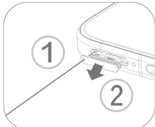
2. Posiziona la scheda nano-SIM nel supporto per SIM 1 o SIM 2 seguendo la direzione della freccia, come mostrato nell'illustrazione. Assicurati di allineare l'angolo obliquo alla tacca sul supporto.
