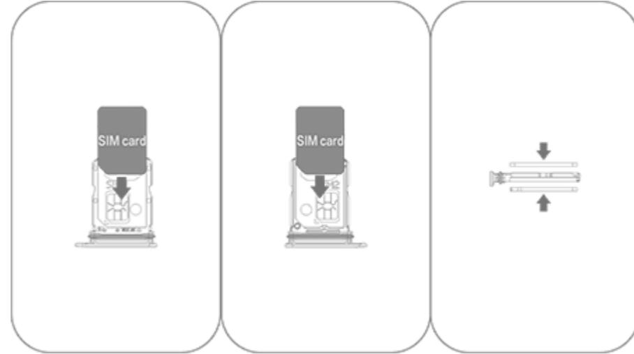
3. Pon el dispositivo boca arriba y luego mete la bandeja deslizándola en la ranura en la dirección que indica la flecha.
