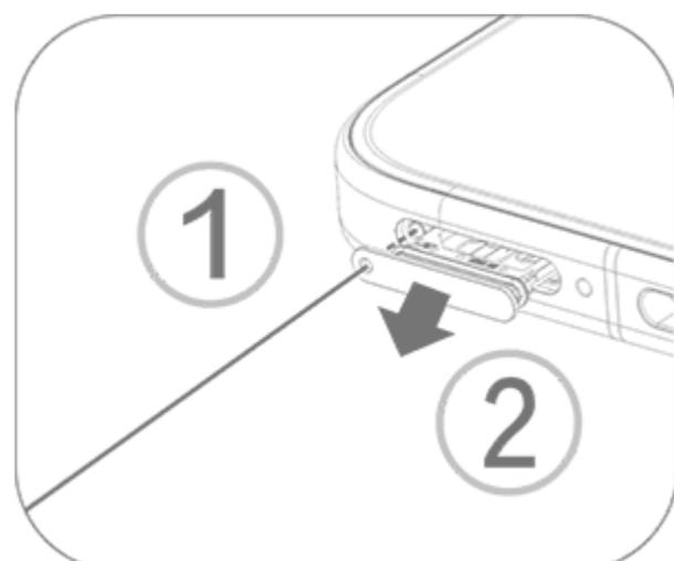
2. Coloca la tarjeta nano-SIM en el soporte de SIM 1 o SIM 2 en la dirección de la flecha, tal como se muestra en la ilustración.
