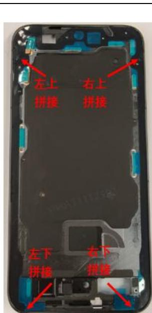
Se l'adesivo applicato è in eccesso e fuoriesce internamente, rimuoverlo utilizzando uno strumento di leva. In caso di applicazione non uniforme della colla, aiutarsi con l'applicatore per regolare il percorso di applicazione e garantire una copertura uniforme. Infine, staccare tutte le pellicole protettive dai nastri biadesivi.
