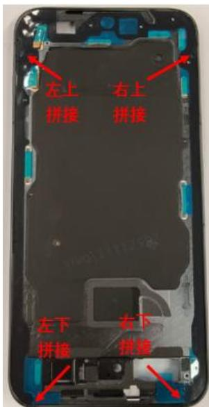
(Si se aplica un exceso de adhesivo y se desborda en el interior, quítelo usando una herramienta de palanca. Si la aplicación del pegamento es irregular, ajuste la trayectoria de aplicación con la aguja para garantizar una cobertura uniforme. Para finalizar, retire todas las películas protectoras de las cintas de doble cara.
