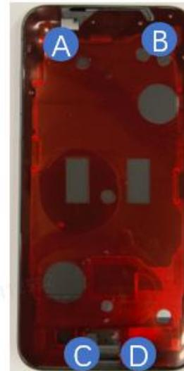
Paso 3: Aplique pegamento a las juntas de las cuatro esquinas. Antes de la aplicación, borre los restos de pegamento de la punta de la aguja para garantizar un flujo adecuado del mismo. (Después de extenderlo, asegúrese de que el pegamento une completamente las dos partes y no se filtra sobre el marco).
