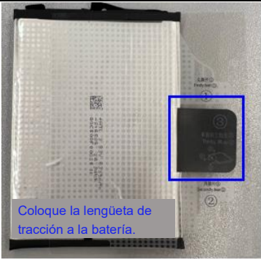
Retire el revestimiento 2 y pegue toda la película de PET.
