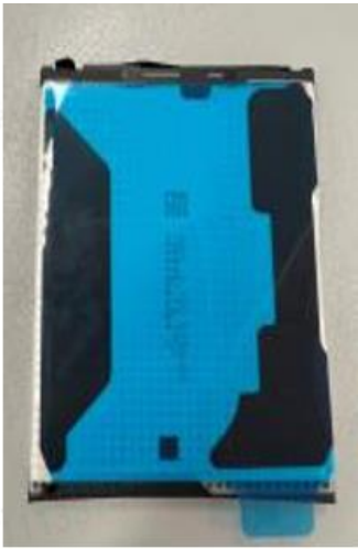
Retire el revestimiento 2 y pegue toda la película de PET.
