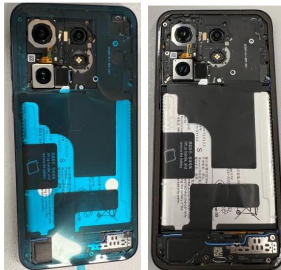
Schritt 2: Richten Sie die hintere Abdeckung passgenau darüber aus und drücken Sie sie fest auf den mittleren Rahmen. Nehmen Sie ein fusselfreies Tuch und drücken Sie auf die Klebeflächen, damit die Abdeckung gut anhaftet.
