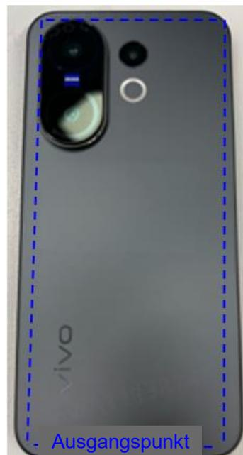
Führen Sie das Hebelwerkzeug nicht tiefer als 5 mm ein, um die internen Schaltkreise nicht zu beschädigen.
