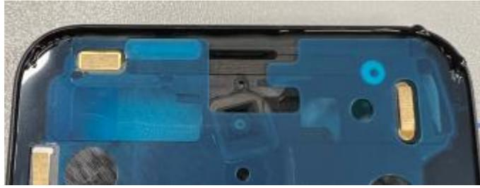
Schritt 5: Setzen Sie das Display-FPC wie in der Abbildung gezeigt in den FPC-Steckplatz im mittleren Rahmen ein. Setzen Sie das Display auf und richten Sie es am oberen Hauptteil aus, damit sie vollständig einrasten.
