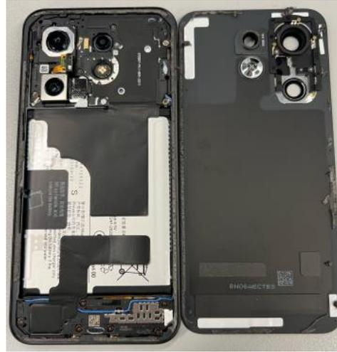
Schritt 7: Reinigen Sie den Geräterahmen und die hintere Abdeckung mit einer spitzen antistatischen Pinzette oder mit den Fingern von Klebstoffresten.
