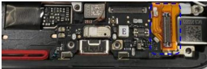
Schritt 3: Schließen Sie das Koaxialkabel und alle BTB-Anschlüsse an.
