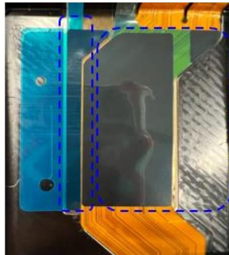
Schritt 5: Stellen Sie vor der Montage sicher, dass Akku und Akkufach frei von Fremdkörpern sind. Entfernen Sie die Schutzfolien von den Klebebändern. Legen Sie den Akku in das Fach ein und drücken Sie mit den Fingern auf die angegebenen Klebestellen, um die Verbindung zu aktivieren.
