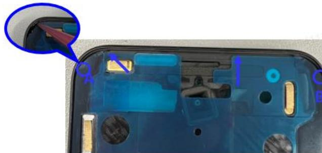
Schritt 4: Entfernen Sie überschüssigen Kleber im Inneren mit einem Hebelwerkzeug. Korrigieren Sie ungleichmäßigen Kleber mit der Applikatorspitze. Die Abbildung auf der rechten Seite zeigt, wie es nach dem ordnungsgemäßen Auftragen des Klebstoffs aussieht. Entfernen Sie dann alle Schutzfolien.
