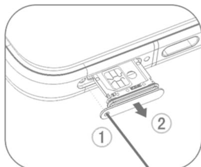
2. Legen Sie Ihre Nano-SIM-Karte in das SIM 1- oder SIM 2-Kartenfach in Pfeilrichtung ein, wie in der Abbildung dargestellt. Stellen Sie sicher, dass die abgewinkelte Ecke an der Aussparung des Faches ausgerichtet ist.
