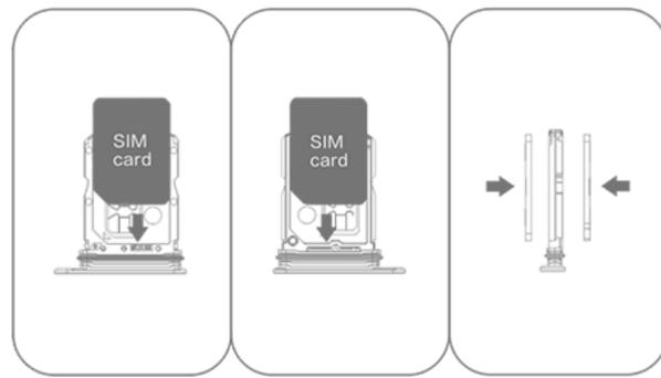
3. Halten Sie das Gerät mit der Vorderseite nach oben und schieben Sie das Kartenfach in die durch den Pfeil angegebene Richtung zurück ins Gerät.
