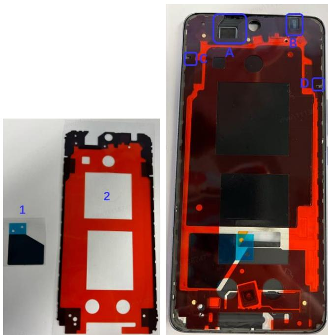
Paso 3: Tome una botella de pegamento, limpie cualquier resto de pegamento curado de la punta del aplicador para asegurar un flujo de pegamento adecuado, y aplique pegamento en el borde inferior del dispositivo. Como se muestra en la Figura 1, comenzando desde el punto A, siga la
