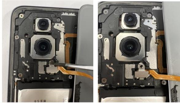
Passaggio 7: rimuovere il connettore del flash (sollevandolo dal bordo inferiore) utilizzando delle pinzette antistatiche.
