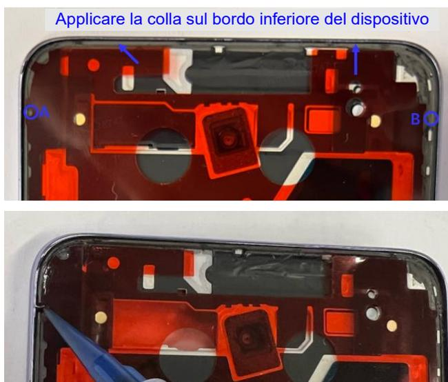
Passaggio 4: rimuovere la colla in eccesso all'interno con uno strumento apposito. Correggere eventuali irregolarità della colla con la punta dell'applicatore. La figura a destra mostra il risultato in seguito alla corretta applicazione della colla. Rimuovere quindi tutti i
