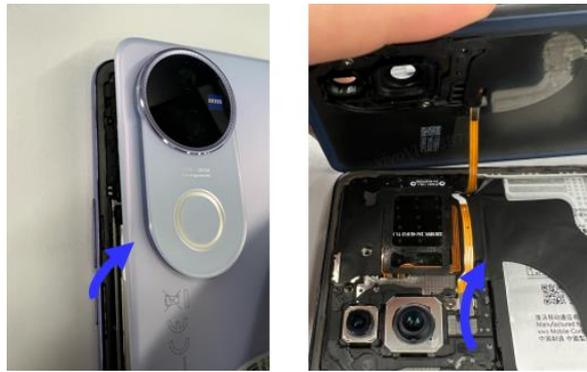
Passaggio 6: utilizzando un cacciavite, rimuovere prima la vite che fissa la staffa in metallo del connettore del flash e successivamente rimuovere la staffa.
