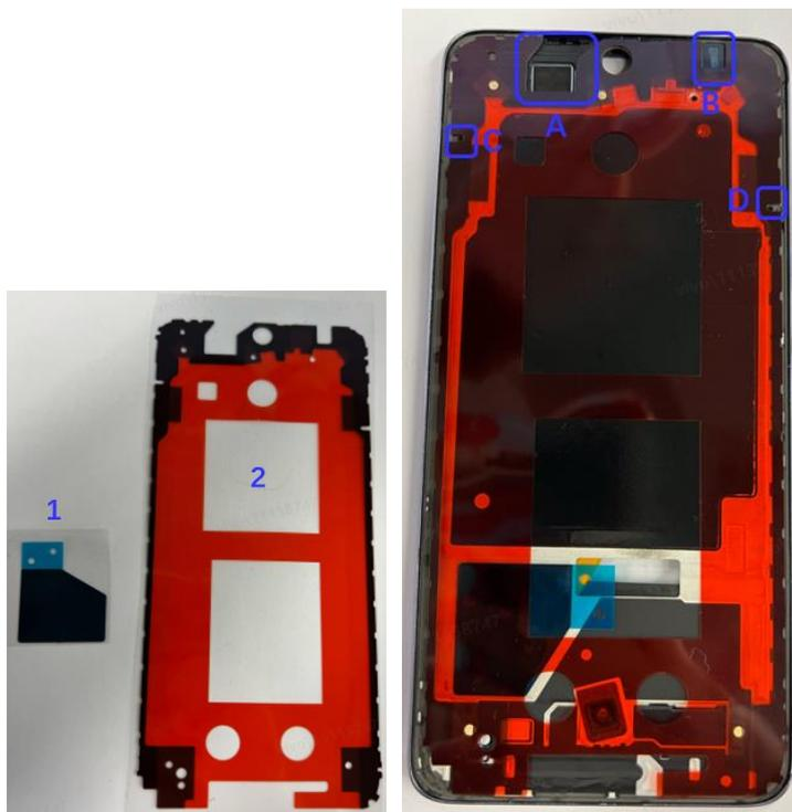
Passaggio 3: prendere un flacone di colla, rimuovere eventuali residui di colla indurita dalla punta dell'applicatore in modo da garantire una corretta fuoriuscita della colla stessa e applicare quest'ultima sul bordo inferiore del dispositivo. Come mostrato nella Figura 1, partendo dal punto A, seguire la freccia lungo il bordo stretto fino al punto B (inclinare leggermente la punta contro il bordo per un controllo preciso).
