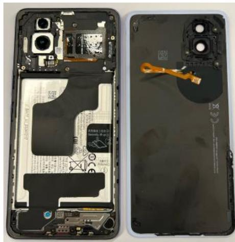
Passaggio 9: rimuovere i residui di adesivo dal telaio del dispositivo e dalla cover posteriore utilizzando delle pinzette appuntite o le dita.
