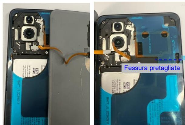
Passaggio 3: allineare con precisione la cover posteriore e premere in modo deciso sulla parte centrale del telaio. Avvolgendo le dita in un panno privo di lanugine, premere le zone adesive per consentire l'incollaggio.
