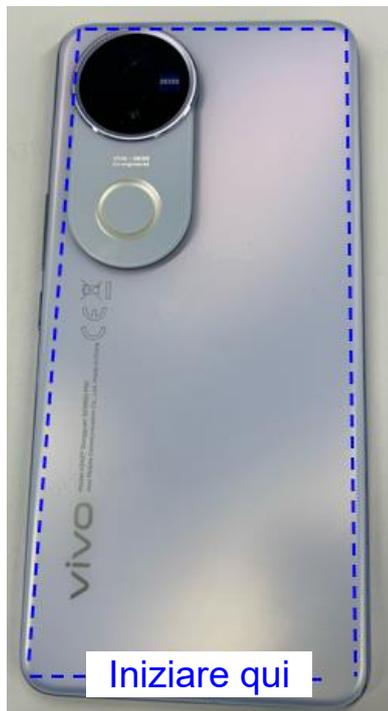
Non inserire lo strumento di leva per oltre 5 mm, altrimenti i circuiti interni potrebbero danneggiarsi.
