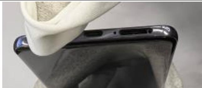
Schritt 7: Umwickeln Sie Ihre Finger nach der Montage mit einem flusenfreien Tuch und drücken Sie 1 Minute lang fest auf alle Klebestellen, um die Verklebung zu aktivieren.
