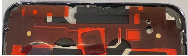
Schritt 5: Führen Sie die Display-FPC durch den FPC-Schlitz im mittleren Rahmen, wie in der Abbildung gezeigt. Bringen Sie das Display in Position, richten Sie es am oberen Hauptteil aus und lassen Sie es vollständig einrasten.
