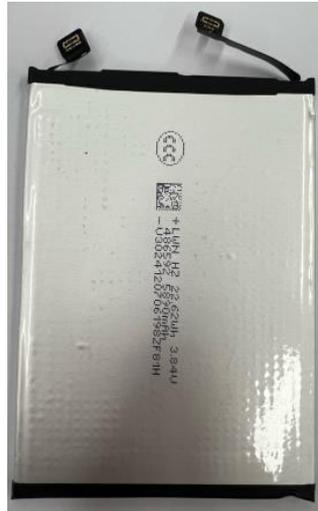
Schritt 2: Reinigen Sie den oberen Hauptteil und den Akku von Klebstoffresten. Entfernen Sie alle Reste des schwarzen Klebstoffs von den angegebenen Bereichen. Entfernen Sie auch die PET-Folie vom alten Akku.
