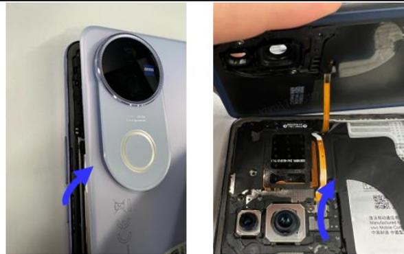
Schritt 6: Entfernen Sie mit einem Schraubendreher die Schraube, mit der die Metallhalterung des Blitzanschlusses befestigt ist, und nehmen Sie die Metallhalterung heraus.
