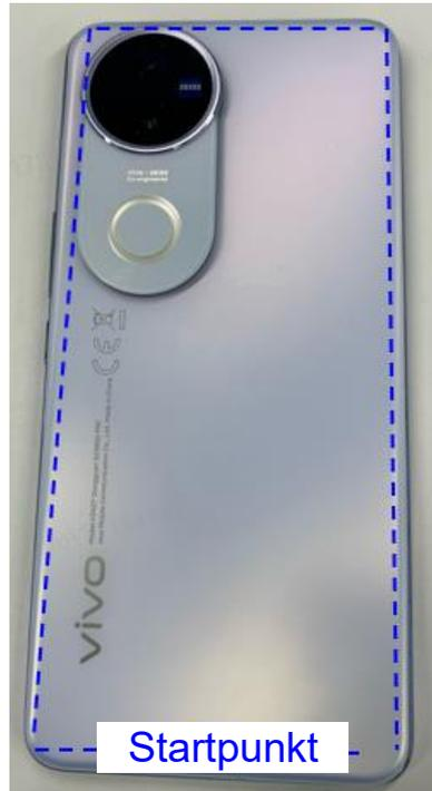
Führen Sie das Hebelwerkzeug nicht tiefer als 5 mm ein, um die internen Schaltkreise nicht zu beschädigen.
