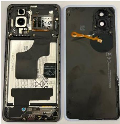
Schritt 9: Entfernen Sie Klebstoffreste mit einer spitzen antistatischen Pinzette oder den Fingern vom Rahmen und der hinteren Abdeckung des Geräts.
