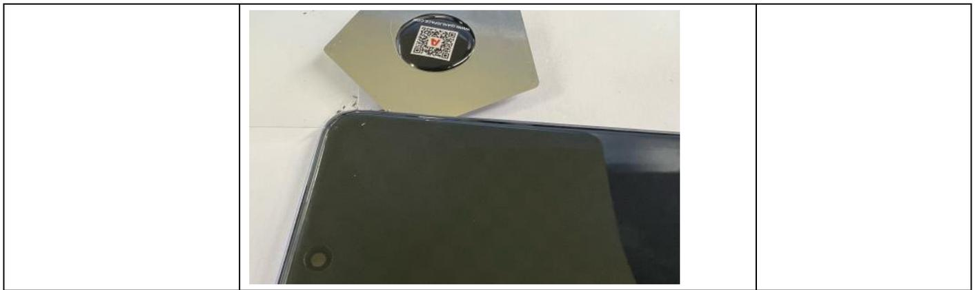
Schritt 7: Nachdem Sie alle Kanten gelöst haben, entfernen Sie das Display vorsichtig, indem Sie es nach oben anheben.
