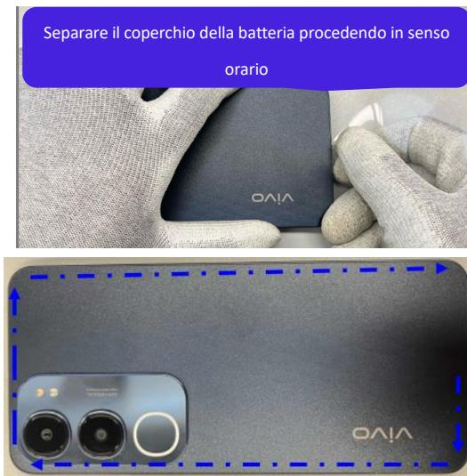
Passaggio 5: una volta aperti i bordi, sollevare delicatamente il coperchio della batteria dalla posizione mostrata in figura.
