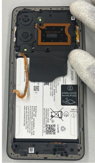
Passaggio 5: inserire e serrare tutte le 17 viti per completare la reinstallazione del telaio.
