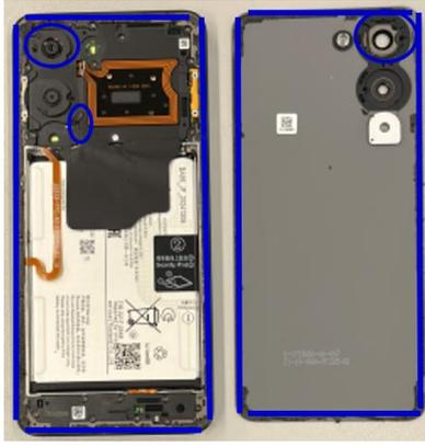
Non toccare le fotocamere posteriori o l'obiettivo sul coperchio della batteria con le dita o con corpi estranei e fare attenzione a non danneggiare i componenti circostanti.
