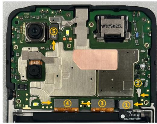
Passaggio 4: rimuovere la fotocamera anteriore e la fotocamera a effetto bokeh utilizzando delle pinzette antistatiche. Prima della rimozione, staccare il nastro conduttivo delle fotocamere, quindi staccare le fotocamere nella direzione indicata dalle frecce.
