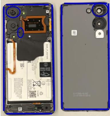
No toque las cámaras traseras ni la lente de la tapa de la batería con los dedos ni con ningún objeto extraño y evite dañar los componentes cercanos.
