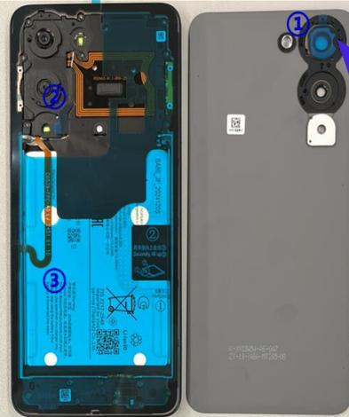
Richten Sie die Folie mithilfe der Klebkerbe aus und achten Sie darauf, dass die Abziehlasche der Schutzfolie nach oben zeigt.
