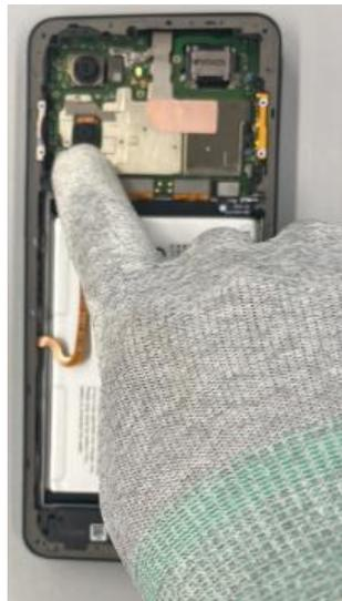
Schritt 3: Montieren Sie die Hauptplatinenhalterung. Richten Sie die Hauptplatinenhalterung anhand des Kameramoduls als Referenzpunkt aus. Drücken Sie auf die beiden angegebenen Stellen, um sie zu befestigen.
