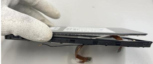
Schritt 9: Das Display ist nun entfernt.
