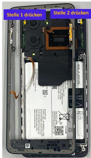
Schritt 4: Montieren Sie den Rahmen. Drücken Sie auf den Rahmen im Uhrzeigersinn, damit er vollständig einrastet.
