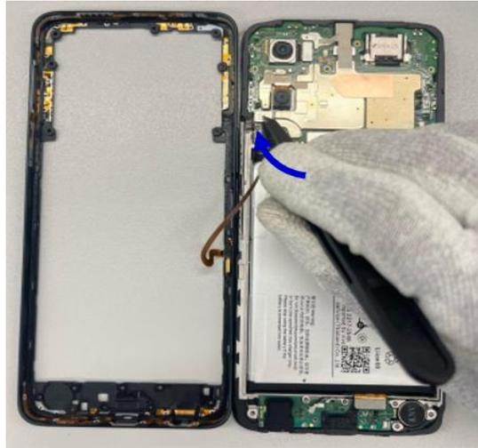
Schritt 7: Das Zerlegen des Rahmens/der Hauptplatinenhalterung ist nun abgeschlossen.
