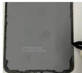
Berühren Sie die Rückkameras oder die Linse der Akkuabdeckung nicht mit den Fingern oder Fremdkörpern und vermeiden Sie eine Beschädigung benachbarter Komponenten.
