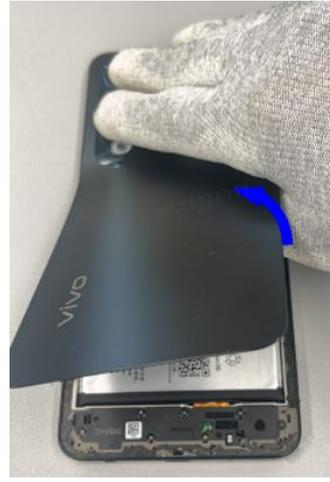
Schritt 6: Trennen Sie die Akkuabdeckung, um das Zerlegen abzuschließen.
