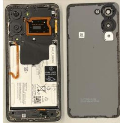
Schritt 7: Entfernen Sie Klebstoffreste von der Akkuabdeckung und der Geräterückseite mit einer spitzen antistatischen Pinzette.
