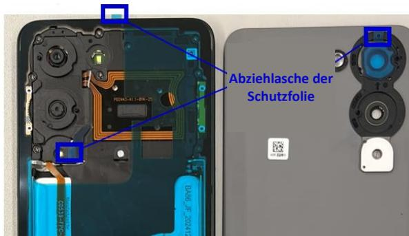
Schritt 3: Richten Sie die Akkuabdeckung am Rahmen aus und drücken Sie sie fest.
