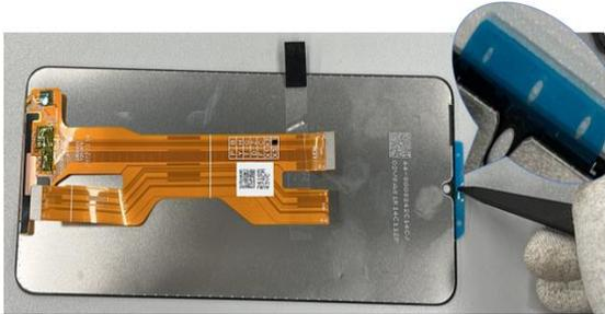
Schritt 4: Tragen Sie Klebstoff auf die obere Abdeckung der Hauptplatine auf. Entfernen Sie vor der Anwendung jeglichen ausgehärteten Kleber von der Applikatorspitze, um einen ordnungsgemäßen Klebstofffluss zu gewährleisten. (Wenn zu viel Klebstoff aufgetragen wird und innen überläuft, entfernen Sie ihn mit einem Hebelwerkzeug. Bei ungleichmäßigem Klebstoffauftrag passen Sie den Dosierweg mit der Applikatorspitze an, um eine gleichmäßige Abdeckung sicherzustellen.)
