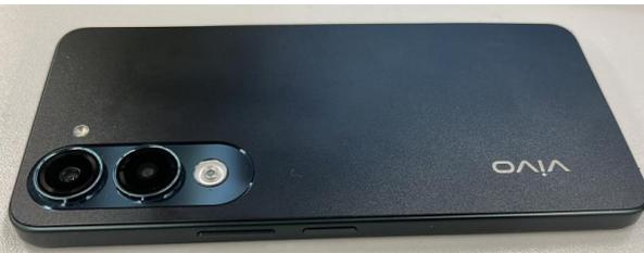
Schritt 4: Wickeln Sie ein fusselfreies Tuch um Ihre Finger und drücken Sie auf die Klebestellen, um den Klebstoff zu aktivieren und die Montage der Akkuabdeckung abzuschließen.
