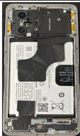
Passaggio 2: inserire e serrare tutte le 16 viti per completare la reinstallazione del telaio.
