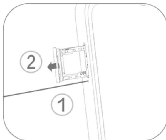
2. Posiziona la scheda nano-SIM nel supporto per SIM 1 o SIM 2 seguendo la direzione della freccia, come mostrato nell'illustrazione. Assicurati di allineare l'angolo obliquo alla tacca sul supporto.
