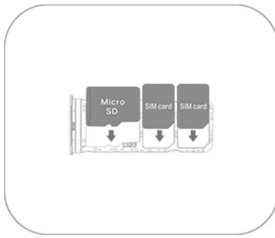
3. Tieni il dispositivo rivolto verso l'alto e fai scorrere il vassoio completamente nello slot nella direzione indicata dalla freccia.
