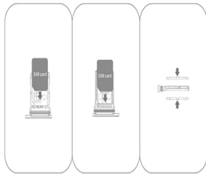
3. Halten Sie das Gerät mit der Vorderseite nach oben und schieben Sie das Kartenfach in die durch den Pfeil angegebene Richtung zurück ins Gerät.
