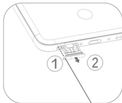
2. Legen Sie Ihre Nano-SIM-Karte in das SIM 1- oder SIM 2-Kartenfach in Pfeilrichtung ein, wie in der Abbildung dargestellt. Stellen Sie sicher, dass die abgewinkelte Ecke an der Aussparung des Fachs ausgerichtet ist.
