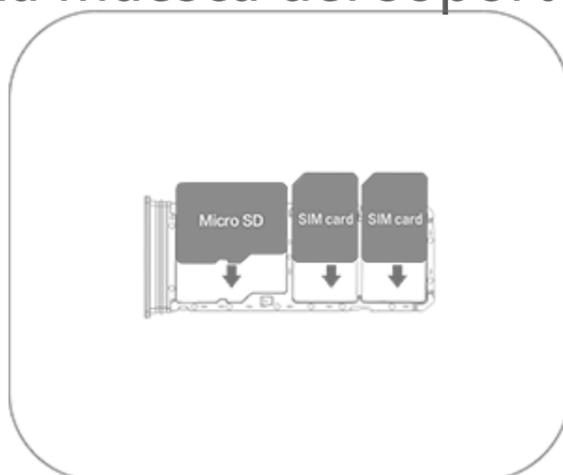
3. Pon el dispositivo boca arriba y luego mete la bandeja deslizándola en la ranura en la dirección que indica la flecha.
