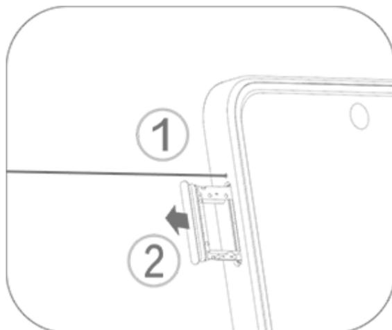
2. Coloca la tarjeta nano-SIM en el soporte de SIM 1 o SIM 2 en la dirección de la flecha, tal como se muestra en la ilustración. Alinea la esquina cortada con la muesca del soporte.
