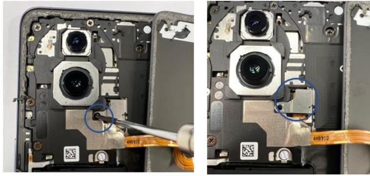
第七步：用静电镊子从连接器右上角移除闪光灯连接器。
