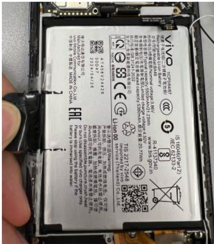
由于内部电路可能会损坏, 拆机片插入机身尺寸不要超过 5 毫米
