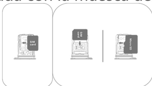
3. Pon el dispositivo boca arriba y luego mete la bandeja deslizándola en la ranura en la dirección que indica la flecha.
