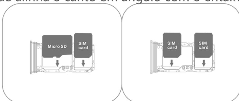
3. Segure o dispositivo virado para cima e, em seguida, faça deslizar o tabuleiro totalmente para dentro da ranhura, na direção indicada pela seta.
