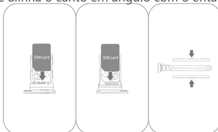
3. Segure o dispositivo virado para cima e, em seguida, faça deslizar o tabuleiro totalmente para dentro da ranhura, na direção indicada pela seta.
