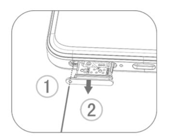
2. Coloca la tarjeta nano-SIM en el soporte de SIM 1 o SIM 2 en la dirección de la flecha, tal como se muestra en la ilustración. Alinea la esquina cortada con la muesca del soporte.
