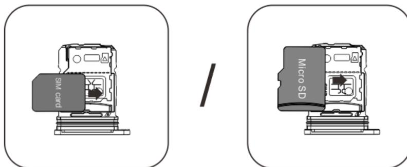
3. Halten Sie das Telefon mit dem Touchscreen nach oben gerichtet und führen Sie den Kartenhalter (mit der Nano- bzw.) in der durch die Pfeile angegebenen Richtung in das Telefon ein.
