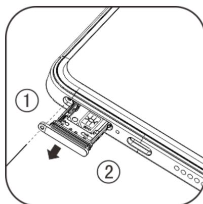
2. Achte auf die Richtung des Pfeils im Diagramm und setze die SIM-Karte mit der abgewinkelten Ecke in die abgewinkelte Ecke des Einschubs ein.
