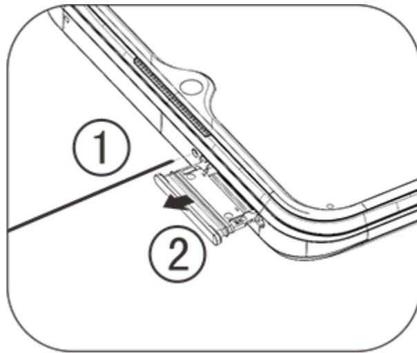
2. Obratite pozornost na smjer strelice prikazan na slici i postavite odrezani kut SIM kartice u odrezani kut ladicu.
