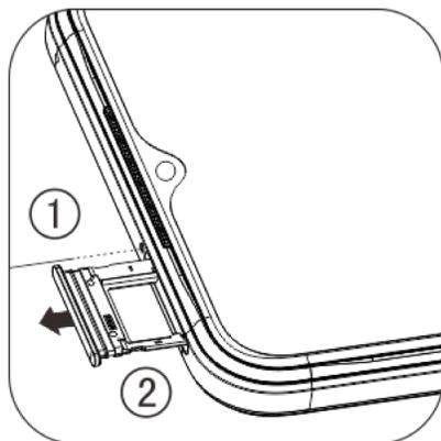
2. Obratite pozornost na smjer strelice prikazan na slici i postavite odrezani kut SIM kartice u odrezani kut ladice.
