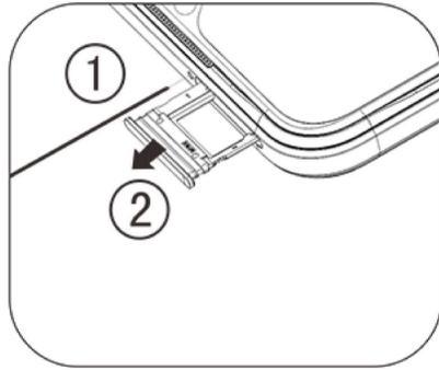
2. Siga a direção da seta indicada no diagrama e encaixe o canto angular do seu cartão SIM no canto angular da bandeja.
