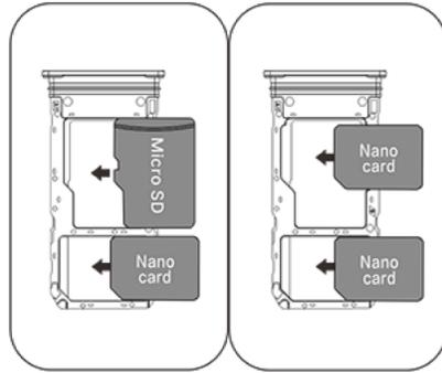
3. Con il touch screen rivolto in alto, segui la direzione della freccia per installare il vassoio nel telefono.
