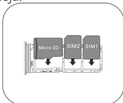
3. Con el teléfono boca arriba, siga la dirección de la flecha para colocar la bandeja (con la tarjeta nano ).
