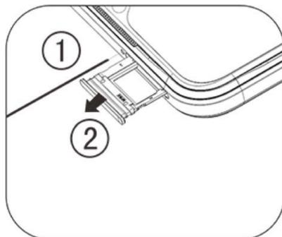
2. Fíjate en la dirección de la flecha del diagrama y haz coincidir la esquina angulada de la tarjeta SIM con la esquina angulada de la bandeja.
