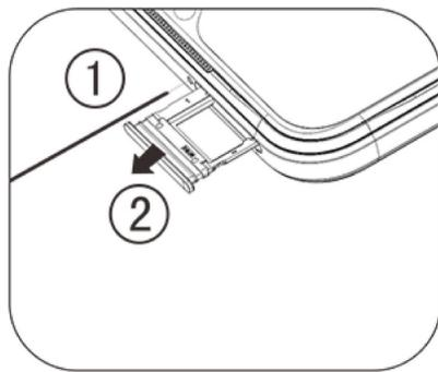
2. Achten Sie auf die Richtung des Pfeils im Diagramm und setzen Sie die SIM-Karte mit der abgewinkelten Ecke in die abgewinkelte Ecke des Einschubs ein.
