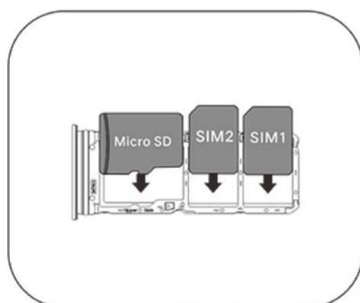
3. Con il touch screen rivolto in alto, segui la direzione della freccia per installare il vano nel telefono.
