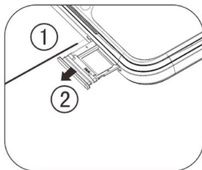
2. Segui la direzione della freccia mostrata nello schema e inserisci l'angolo obliquo della scheda SIM in quello uguale del portataschede.
