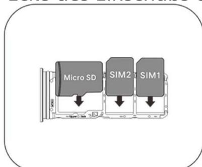
3. Halten Sie das Telefon mit dem Touchscreen nach oben gerichtet und führen Sie den Kartenhalter (mit der Nano-Karte) in der durch die Pfeile angegebenen Richtung in das Telefon ein.
