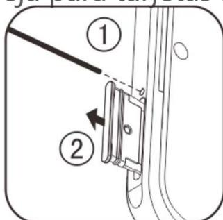
2. Coloque la parte metálica de la tarjeta nano (SIM1/SIM2) o Micro SD hacia abajo haciendo coincidir el ángulo oblicuo de la tarjeta con el de la bandeja. Coloque la tarjeta nano (SIM1/SIM2) o Micro SD en la ranura para tarjetas siguiendo la dirección de las flechas del diagrama.
