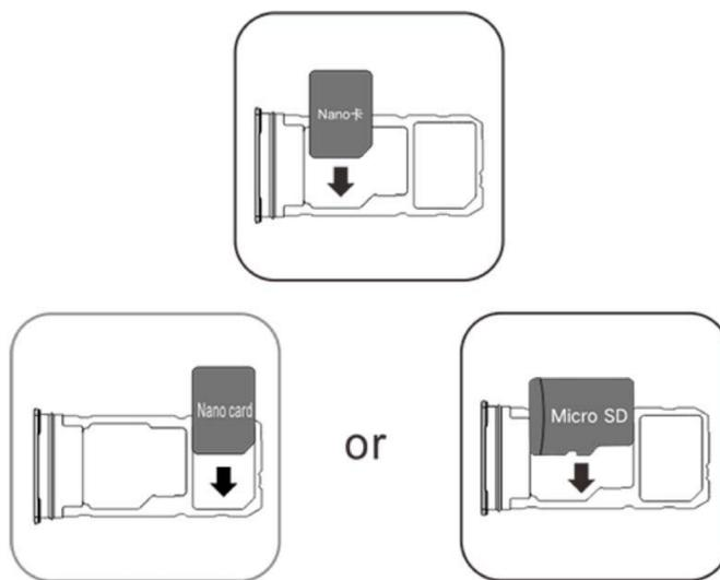
3. Con el teléfono boca arriba, siga la dirección de la flecha para colocar la bandeja (con la tarjeta nano o Micro SD).
