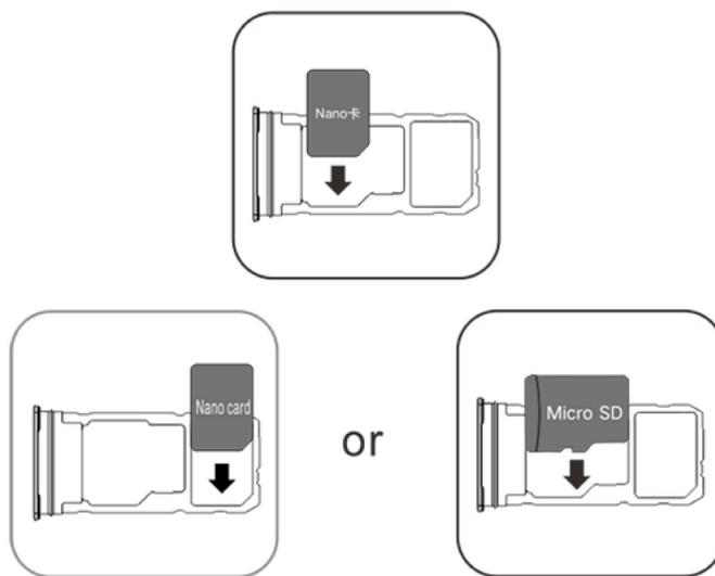
3. Halten Sie das Telefon mit dem Touchscreen nach oben gerichtet und führen Sie den Kartenhalter (mit der Nano- bzw. microSD-Karte) in der durch die Pfeile angegebenen Richtung in das Telefon ein.
