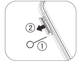
2. Orientez vers le bas la face métallique de la carte Nano (SIM1/SIM2) ou de la carte Micro SD, en plaçant l'angle oblique face à celui du plateau de carte. Insérez la carté Nano (SIM1/SIM2) ou Micro SD dans le logement de carte en respectant le sens indiqué par les flèches du diagramme.
